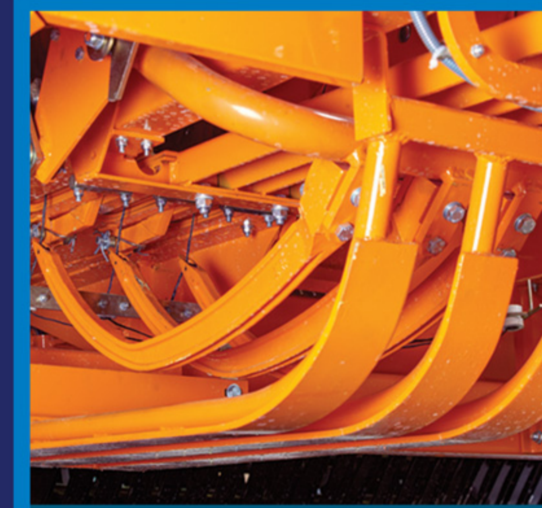
Zorlu arazi şartlarında iğnelere zarar vermeyen iğne koruma sistemi
